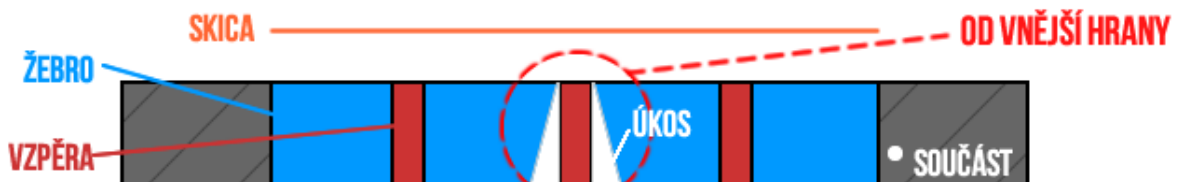
Obr. 5 – Úkos vzpěry od vnější hrany.
